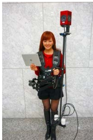
歩くだけで周囲を3D計測できる「Robot Eye Walker 4D」の計測機器(左)と計測中の様子(右) (写真・資料:特記以外はU's Factory)
