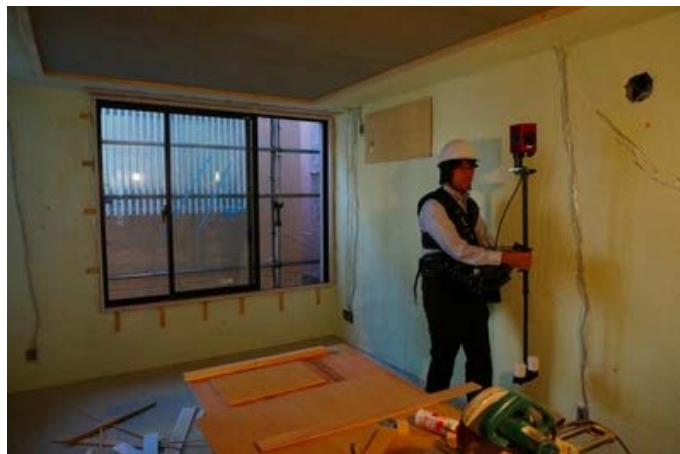
歩くだけで周囲を3D計測できる「Robot Eye Walker 4D」の計測機器(左)と計測中の様子(右) (写真・資料:特記以外はU's Factory)
